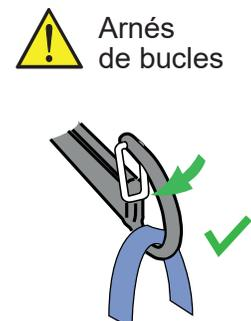
Inserte el bucle de sujeción en el gancho. Asegúrese de que el pestillo de seguridad esté cerrado.
