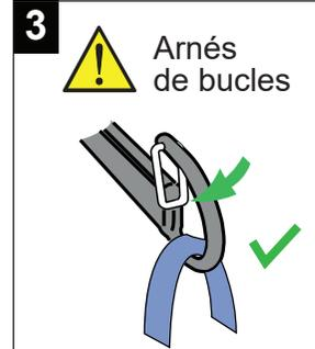
Inserte el bucle de sujeción en el gancho. Asegúrese de que el pestillo de seguridad esté cerrado.
